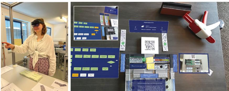
Abb. 8b: High-Fidelity-Prototypen auf Grundlage der Nutzerstudien und der iterativen Weiterentwicklung. Bildausschnitte des Prototyps mit einer optical see-through AR-Brille (Microsoft HoloLens 2) (Quelle: Jannike Illing, OFFIS e. V. Oldenburg).
